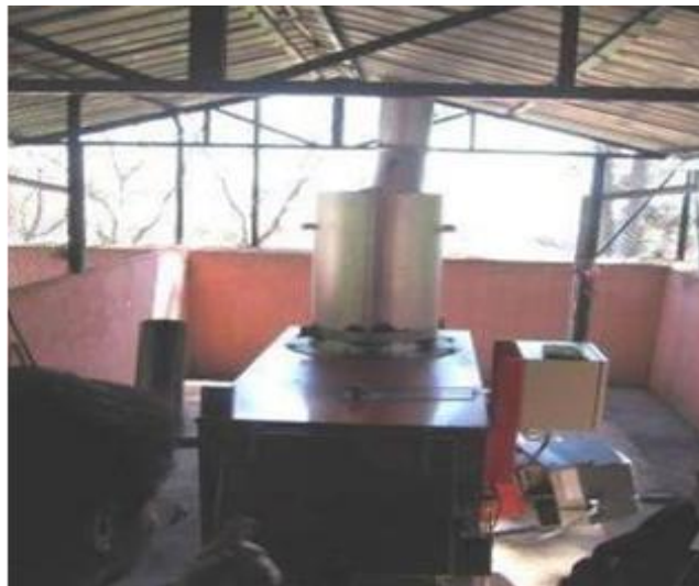
Figure 2: Incinérateur à double chambre IPM
